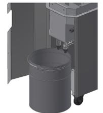
分離槽内の浮上回収油は比重が軽いため、量が増すにつれ少しずつ液面が上昇し、排出されますが、回収油の排出が進まない場合は排水口キャップを上方に調整し、分離槽内の水位を上げるにより回収油の排出ができますので、適宜調整をお願いします。
