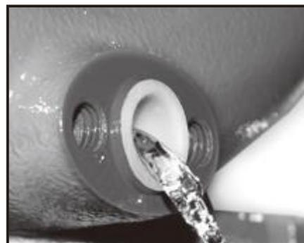
ドレンフランジの六角ボルトを外します。ポンプから液体を抜き、すべての部品をそれぞれ水洗浄してください。
