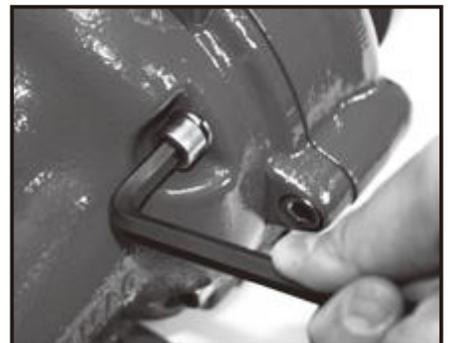
ブラケットにキャップスクリューを4本挿入し、トルク値27N・mで締めます。
