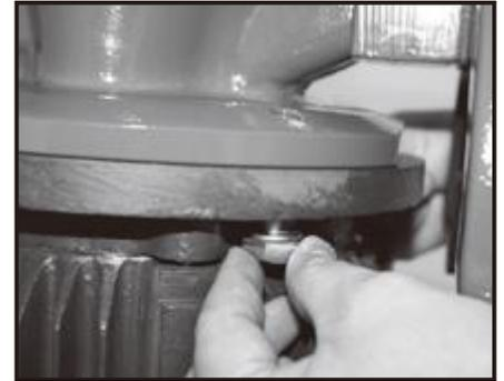
※モータの交換時にはモータフランジ接合面に防水処理（液状ガスケット）を施してください。
