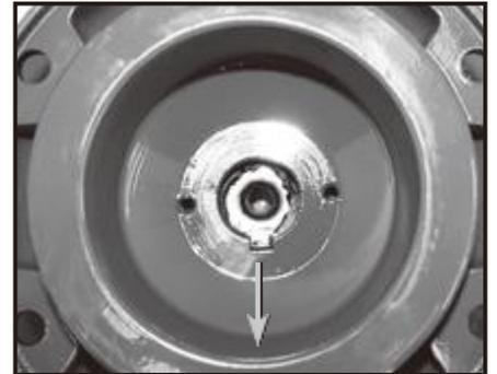
外輪マグネットを、キー溝が下側の位置に来るまで回転させます。(フットアダプタが下側の位置にある時)
