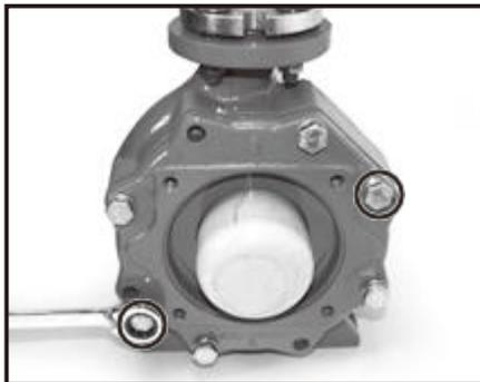
取り外したボルト2本を上記の丸印をつけたジャッキボルト穴に取付け、残り4本のボルトを取り外してください。リアケーシングサポートが自由になるまで取り付けした2本のボルトを均等に締付けてください。
