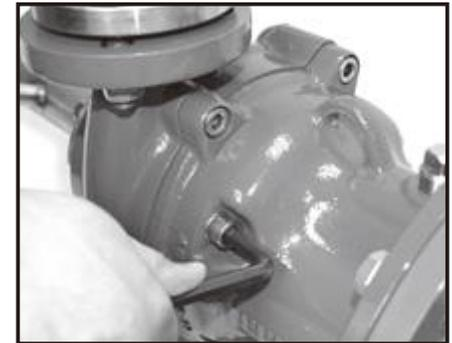
ブラケットの4本のキャップスクリューを、トルク値  $27\text{N} \cdot \text{m}$  で締めます。
