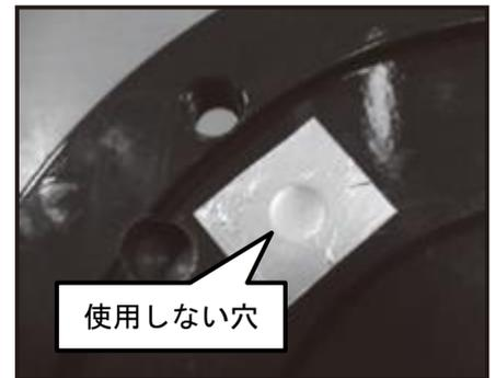
1.5kW ~ 7.5kWまでのモータフレーム取付対応のブラケットを使用する場合、使用しない取付ボルト穴からモータフランジ内側へ浸水する可能性がありますので、使用しない取付ボルト穴をアルミテープ等で塞ぎ、防水処理を行います。但し、使用する取付ボルト穴が一番内側の場合、使用しない外側の取付ボルト穴に防水処理は不要です。
