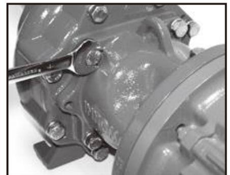
ジャッキボルトを外して、ウェットエンドとドライブエンドをはめ合わせます。ブラケットの六角ボルト4本を挿入し、本ページにあるトルク表のトルク値に従って締めます。
