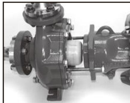
ドライブエンドのジャッキスクリューを伸ばします。ドライブエンドの位置を合わせて、ジャッキスクリューがウェットエンドに届くまで、ドライブエンドを押し入れます。
