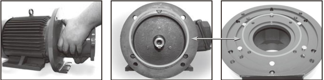
モータにブラケットを取付、モータのフランジとブラケットの位置を合わせます。位置決めのためのピン（構成（または、これがない場合もあります）は、モータのフレームによって違ってきます。
