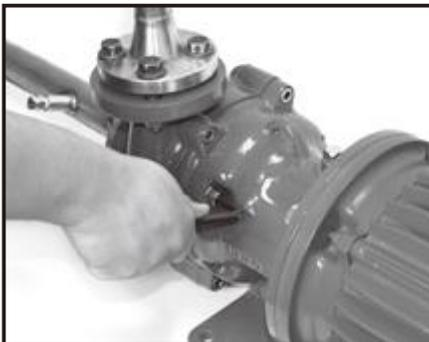
8mm の六角レンチを使って、ブラケットの4本のキャップスクリューボルトを外します。
