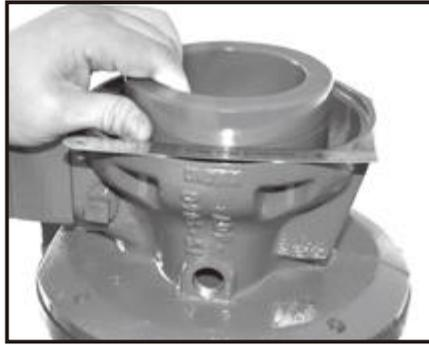
定規などを使って、外輪マグネットの位置合わせの溝を、ブラケットの最上部の端と合わせます。
