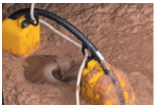
稼働時 ゲートリング部が浮上し揺動
