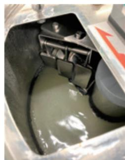
油排出口部にスクレーパを取り付けることで、表層油を掻き出し排出を促します。
