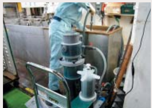
デモ写真：プラスチックめっきの治具剥離槽に沈殿するスラリー回収
